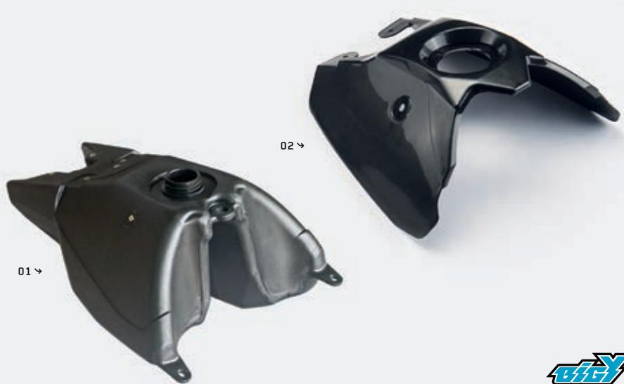
RÉSERVOIR ET COUVRÉ RÉSERVOIR YCF POUR BIGY
